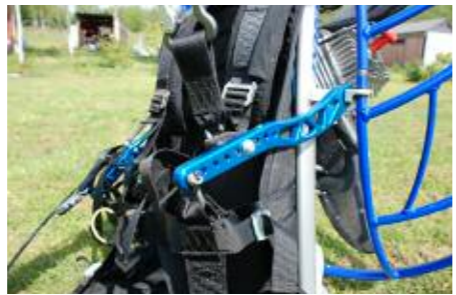
効果的な体重移動を行えるスイングアームシステム。
