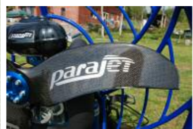
プロペラはシミター社製カーボンファイバーだ。
