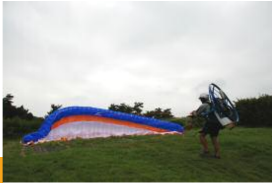
ハングポイントが低いいため、ライズアップには何のストレスもない。
